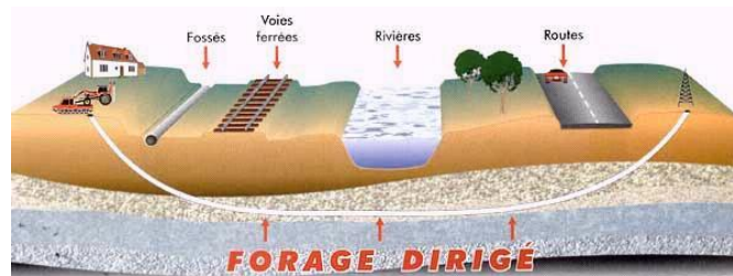
FIGURE 5 : EXEMPLE DE FORAGE DIRIGÉ (SOURCE : CONTANT.FR)
